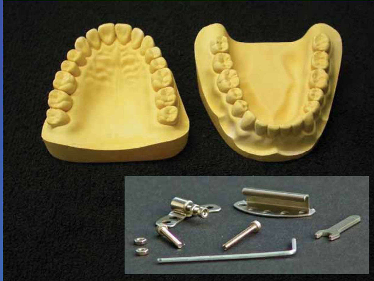
Meistermodelle mit Schienenzubehör (Justierschrauben, Kontermutter zur Fixierung des Vorschubs, Imbusschraubenschlüssel , Kontermutterschlüssel)
