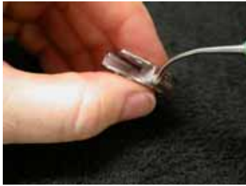
Abb. 11) Auswachsen der Funktionselemente aus Schutzgründen (z.B. Verkleben des Schraubengewindes mit Kunststoffresten)
