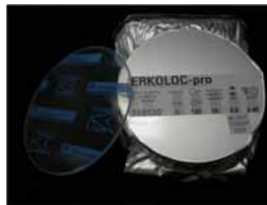
Abb. 2) Zur Herstellung mit Hilfe der Druckformtechnik wird die gebräuchliche thermoforme Tiefziehplatte "Erkoloc Pro" der Erkodent GmbH in der Stärke (2 bis) 3 mm empfohlen. Es können auch vergleichbare Materialien verwendet werden.
